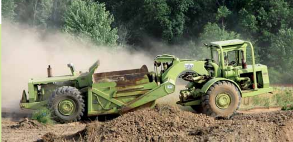
• Terex TS14b Scraper i arbejde et sted Australien. Maskinen findes i vidt forskellige størrelser.
