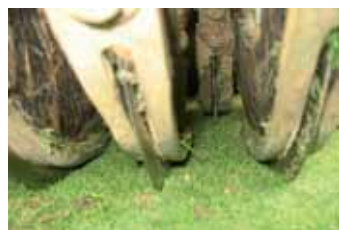
• Vredo Fluid Feeder er en verdensnyhed fra Nellemann Machinery. Den skærer gennem græstørven og placerer nematoder.
