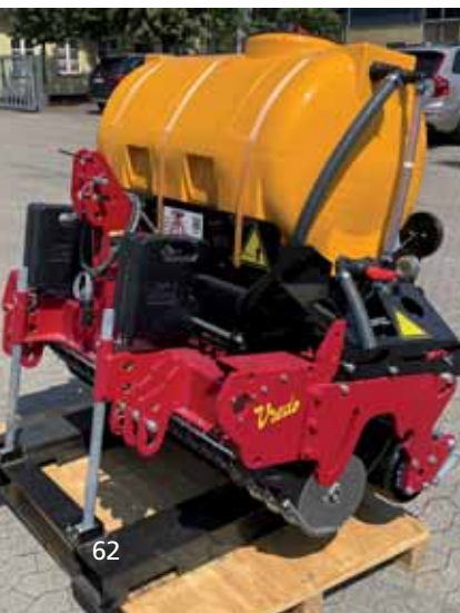
• Vredo Fluid Feeder er en verdensnyhed fra Nellemann Machinery. Den skærer gennem græstørven og placerer nematoder.
