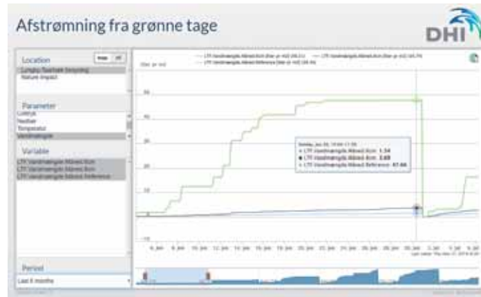
Grafen viser vandtilbageholdelsen fra en af de tre tage ved Lyngby-Taarbæk Forsyning i juni 2019. Der er løbet 47 liter/m 2 af referencetaget (grøn), mens de grønne tage (blå og sort) næsten har opsuget alt.
